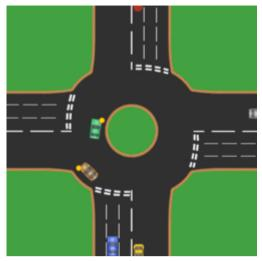
道路が交差する地点の中央に「島」を設けて、それぞれの車が時計回りの一方通行でその「島」のまわりを回るようにすることで、信号なしで車両通行を整理するシステム。1960年代から、イギリスで普及しはじめた。
